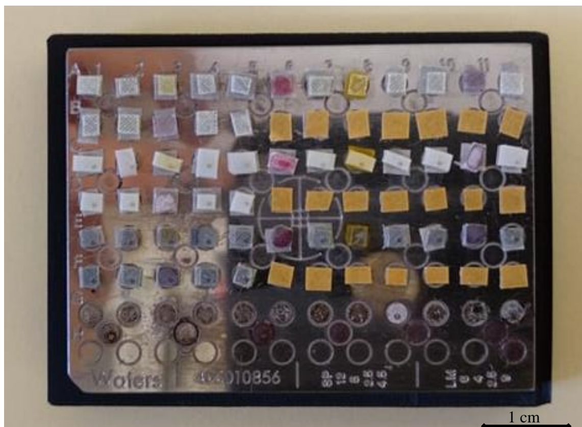
Obr. 16 MALDI destička se vzorky barviv a pigmentů na polymerech: ABS – řada A a B; ABS-TPU – řada C a D; ABS-C – řada E a F; A1/C1/E1 – čistý polymer; pozice A2/C2/E2 – kys. karmínová; pozice A3/C3/E3 – alizarin; A4/C4/E4 – indigo; pozice A6/C6/E6 – safranin; pozice A7/C7/E7 – kvercetin; pozice A8/C8/E8 – beta-karoten; pozice A9/C9/E9 – kvercitrin; pozice A10/C10/E10 – rutin; pozice A11/C11/E11 – oenin chlorid; pozice A12/C12/E12 – kys. ellagová; pozice B1/D1/F1 – katechin; pozice B2/D2/F2 – luteolin; pozice B3/D3/F3 – vitisin A; pozice B4/D4/F4 – kys. gallová; pozice B5/D5/F5 – apigenin
