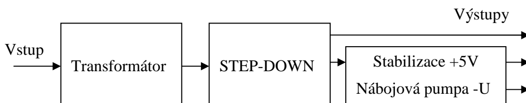
Obr. 6.1: Blokové schéma druhého zdroje
