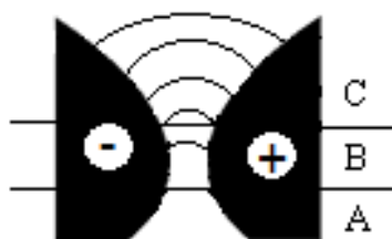
Obr. 5. Fáze klouzavého obloukového výboje: A – oblast elektrického průrazu, B – oblast rovnovážného plazmatu, C – oblast nerovnovážného plazmatu.
