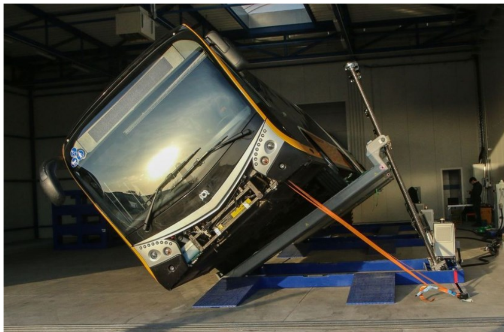
Obr. 20 Zkušebna příčné stability, zkoušení autobusu SOR NS 18 [21]
