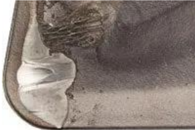
Obr. 18- Výmolové (žlábkové) opotřebení [20]
