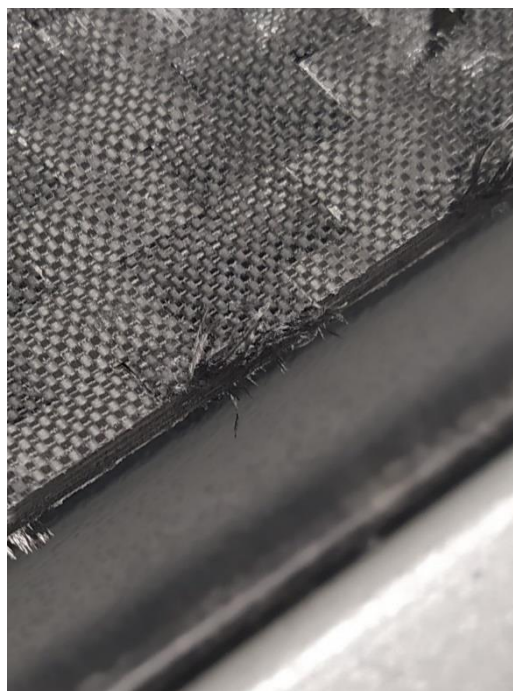
Obr. 44- Detail delaminace vzorku po frézování
