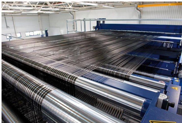
Obr.4- Výroba uhlíkového vlákna ve firmě BMW[8]
