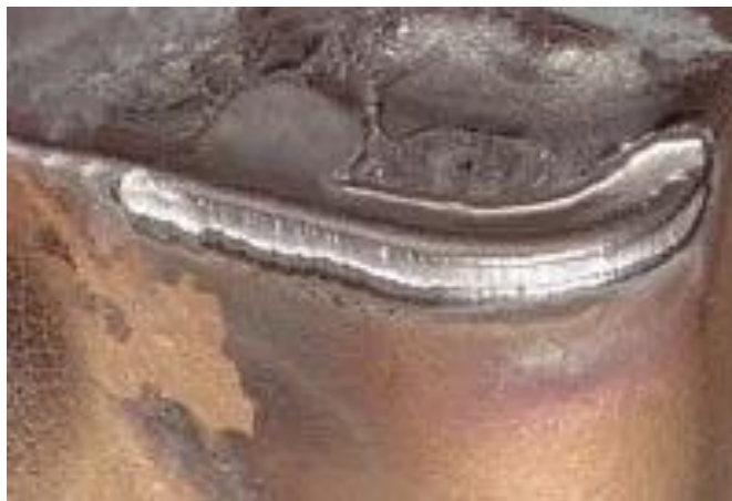
Obr. 17- Opotřebení na hřbetu nástroje [20]
