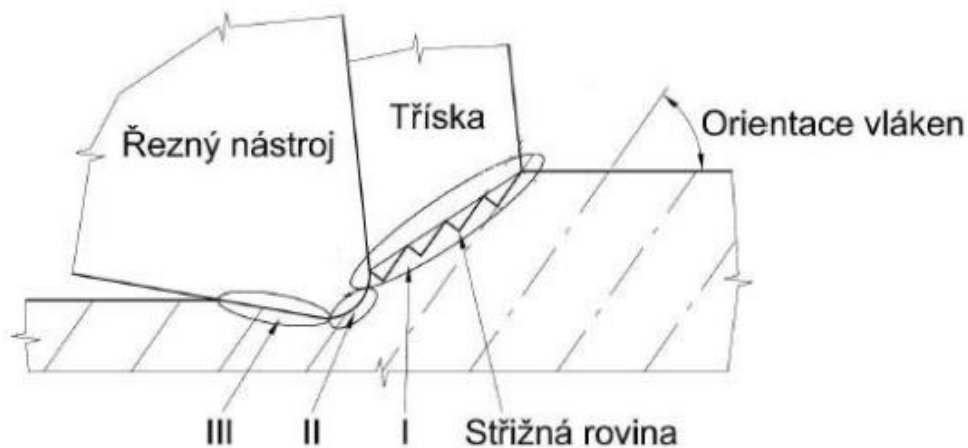
Obr. 8- Deformační oblasti při obrábění kompozitního materiálu[14]
