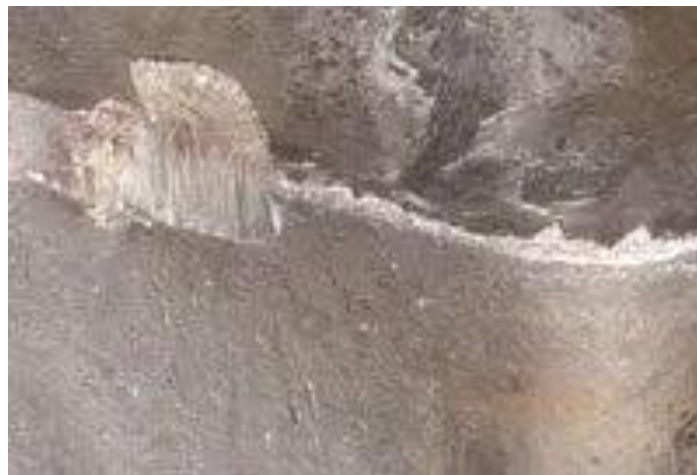
Obr. 19- Nárůstkové opotřebení nástroje [20]
