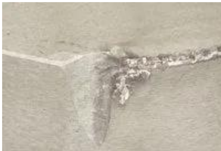
Obr. 22- Vrubové opotřebení nástroje [20]
