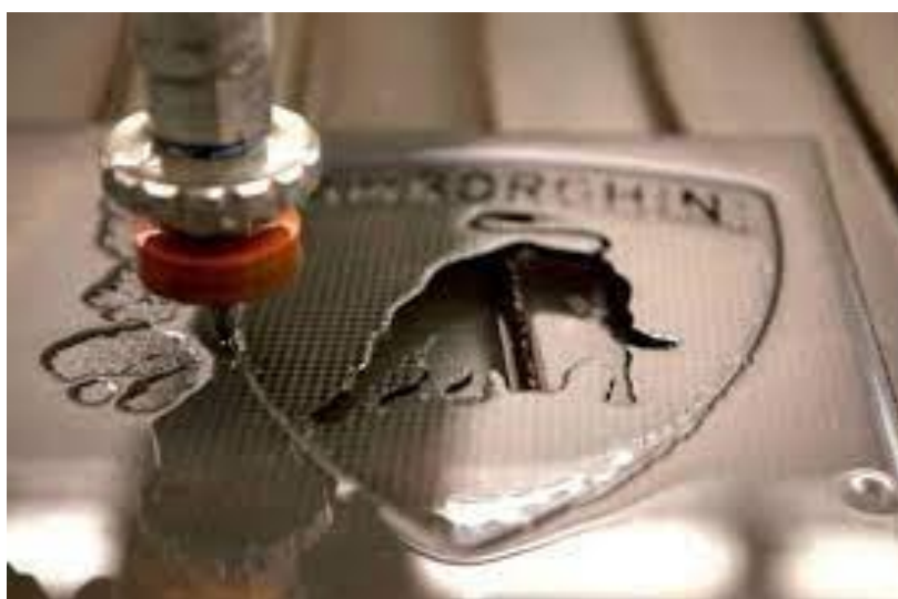
Obr. 5- Obrábění loga Lamborghini z kompozitu s uhlíkovým vláknem pomocí vodního paprsku[10]
