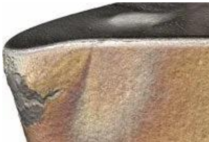
Obr. 21- Plastická deformace nástroje [20]
