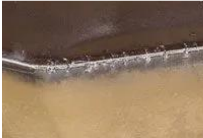
Obr. 20- Tepelné trhliny na nástroji [20]
