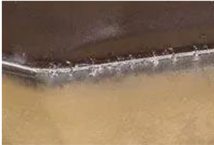
Obr. 20- Tepelné trhliny na nástroji [20]
