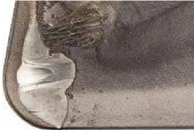
Obr. 18- Výmolové (žlábkové) opotřebení [20]
