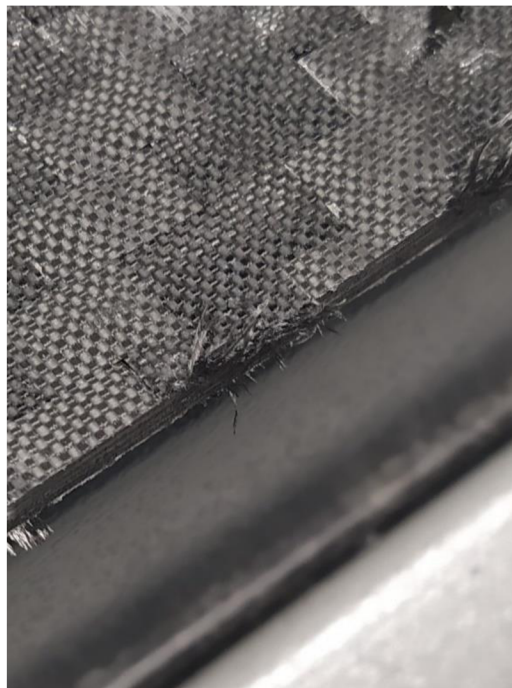
Obr. 44- Detail delaminace vzorku po frézování
