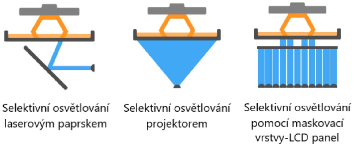
Obr. 11 Způsoby osvětlení SLA technologie [3].
