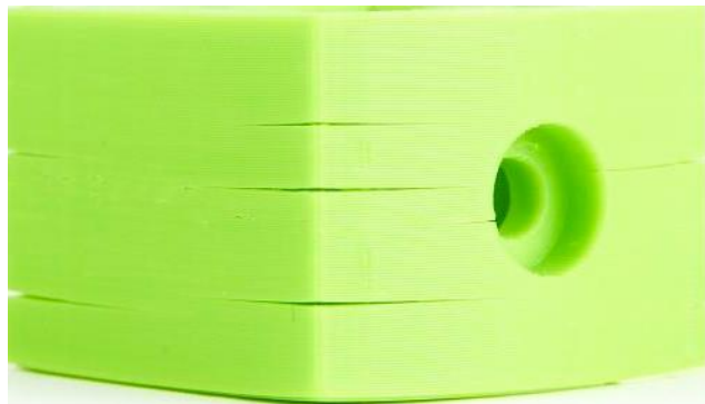
Obr. 4 Vady výtisku vzniklé teplotními rozdíly [17].
