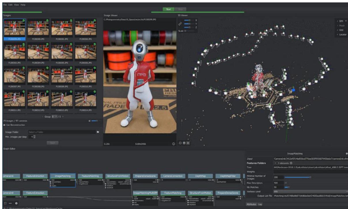
Obr. 31 Tvorba digitálního objektu fotogrametrií [3].
