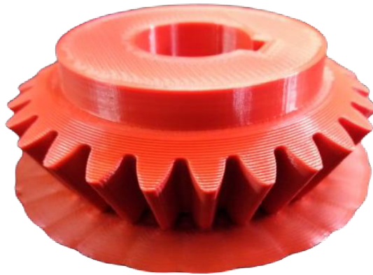
Obr. 53 Vytištěné kuželové ozubené kolo hnací.
