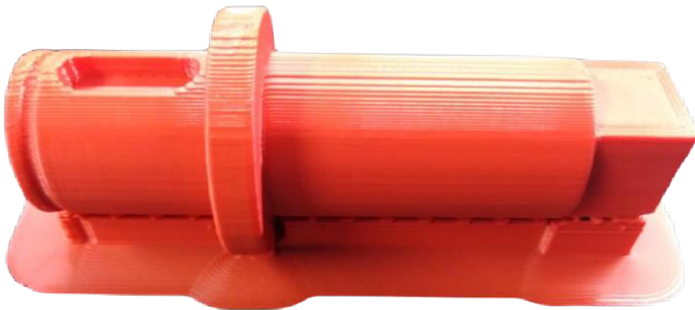
Obr. 56 Vytištěná vstupní hřídel.
