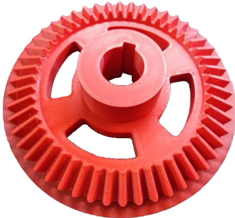
Obr. 54 Vytištěné kuželové ozubené kolo hnané.
