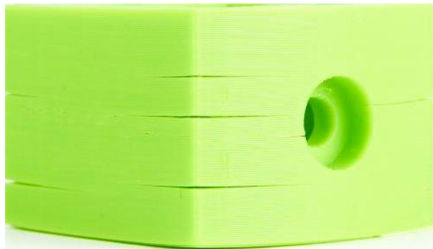
Obr. 4 Vady výtisku vzniklé teplotními rozdíly [17].
