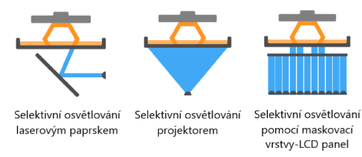
Obr. 11 Způsoby osvětlení SLA technologie [3].
