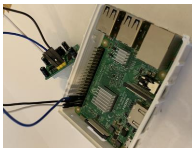
Obrázek 18 Zapojení PIR senzoru
