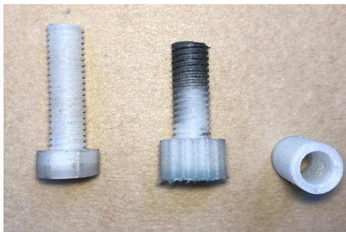
Obrázek 55 : Ukázka tištěného šroubu a ložiska.
