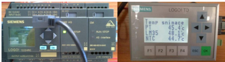
Obr. 7: Použitá konfigurace LOGO! a ovládací panel LOGO! TD.
