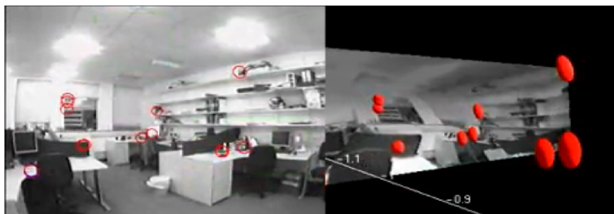
Obrázek 8.2: Rekonstrukce prostoru na základě metody MonoSLAM. Převzato z [39].
