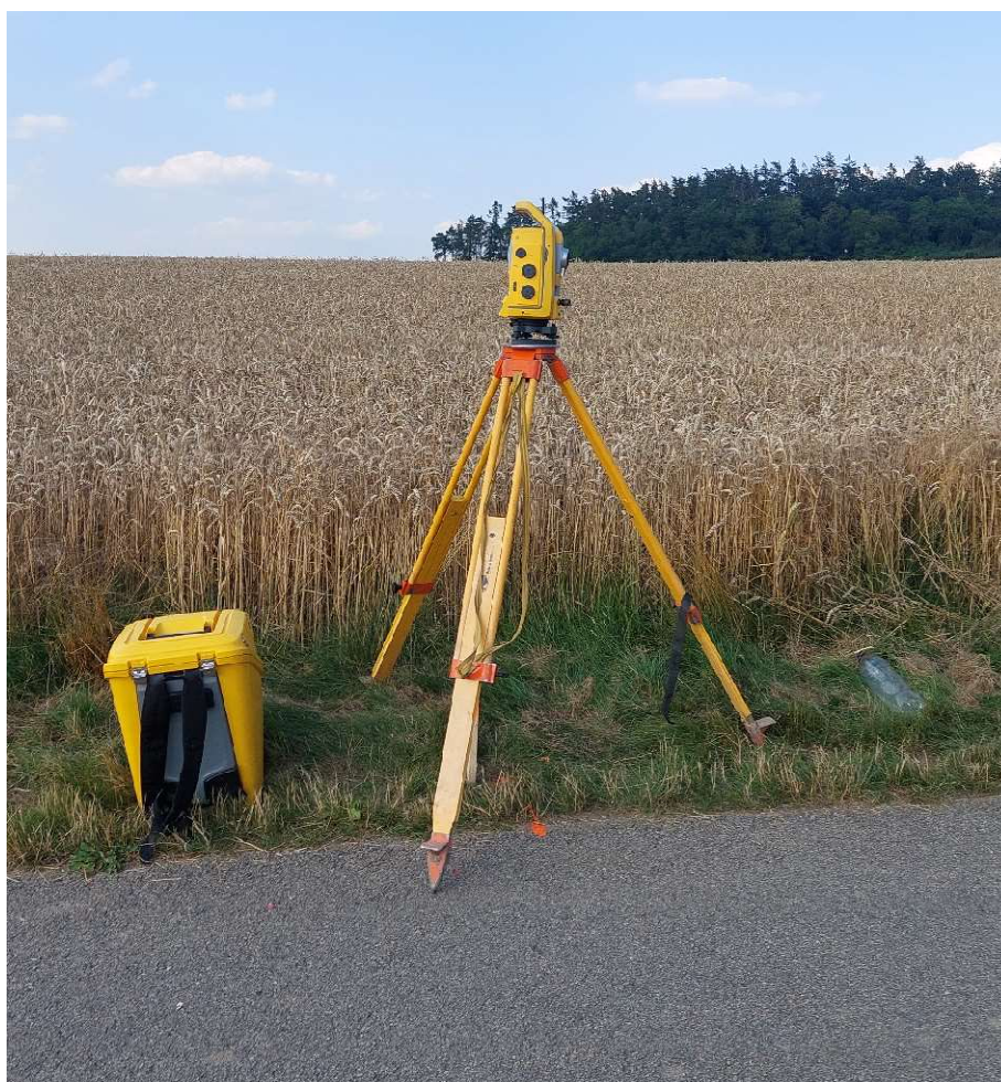
Obrázek 3: Měření robotickou totální stanicí Trimble S5 3" DR PLUS
