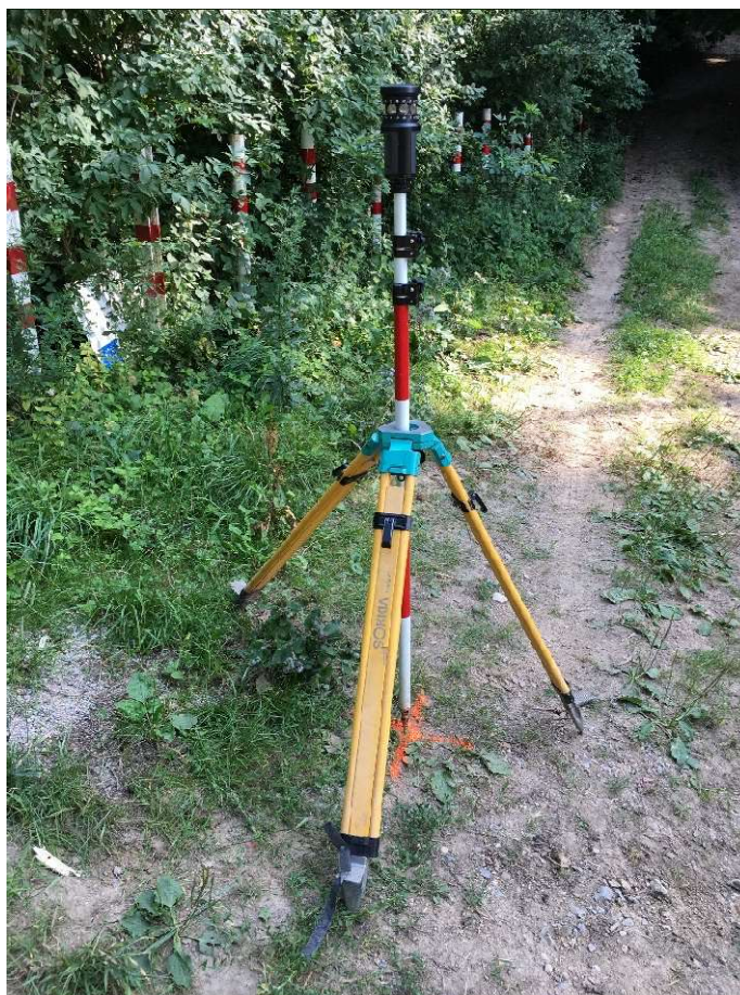
Obrázek 5: Ukázka stabilizování hranolu při orientaci
