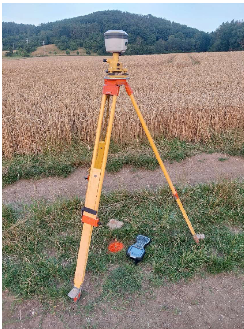
Obrázek 2: Měření GNSS přijímačem Trimble R2
