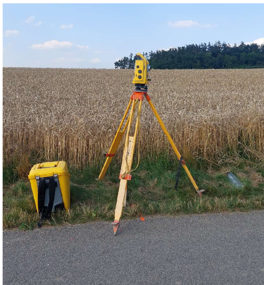
Obrázek 3: Měření robotickou totální stanicí Trimble S5 3" DR PLUS
