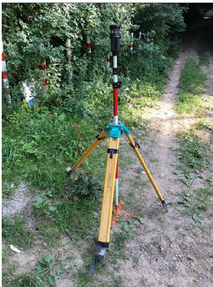
Obrázek 5: Ukázka stabilizování hranolu při orientaci
