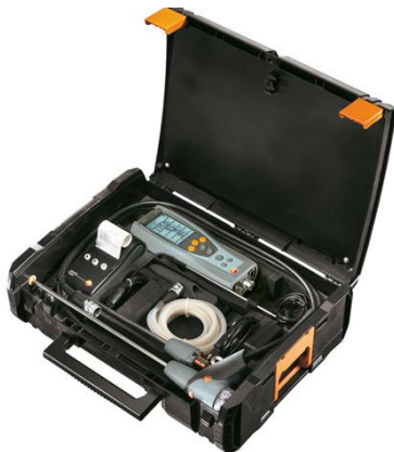
Obrázek 20 Testo 327-1 Analyzátor spalin, sériového čísla 01955271
