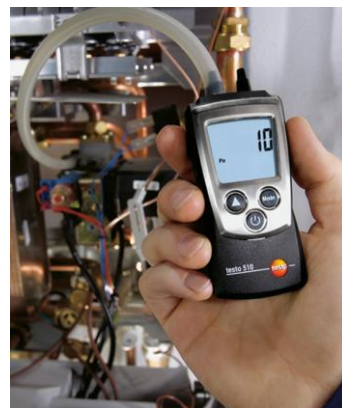
Obrázek 21 Diferenční tlakoměr Testo 510, sériové číslo 00488317
