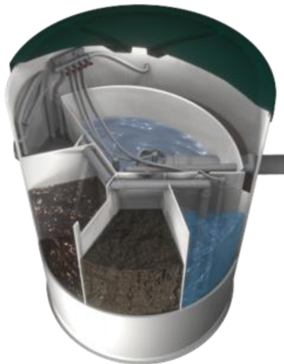
Obr. 7 Řez domovní čistírnou odpadních vod 37
