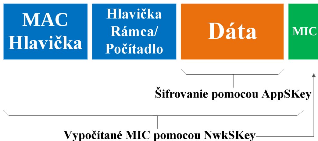
Obr. 3.7: Štruktúra LoRaWAN správy a jej zabezpečenie [17].
