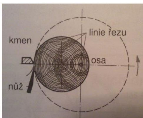
Obr. 3 Excentrické neboli půlkruhové loupání. (Josten a kol. 2010)
