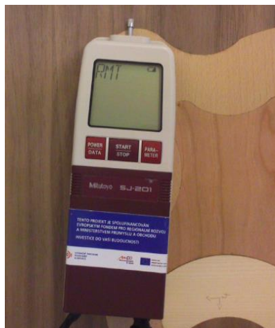
Obr. 26 Přístroj na měření drsnosti SJ -201. Obr. 27 Digitální váha SI – 234A. (Kolomazník – vlastní foto 2015)
