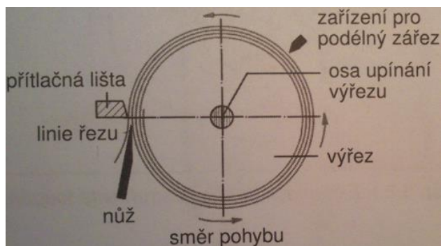
Obr. 2 Centrické loupání dých. (Josten a kol. 2010)
