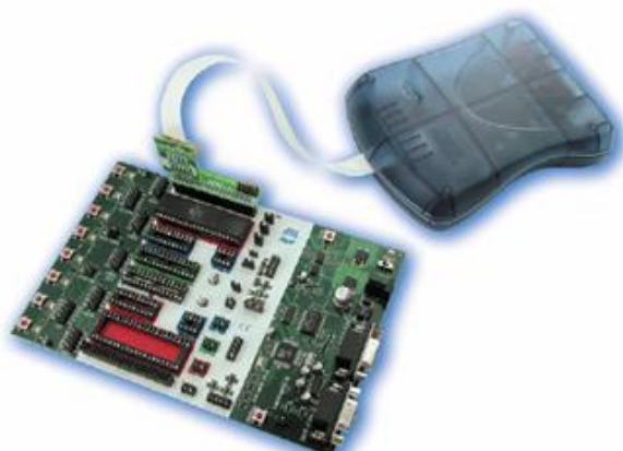
Obr. 4.1: Ukázka spojení JTAG programátoru s programovanou aplikací [7].
