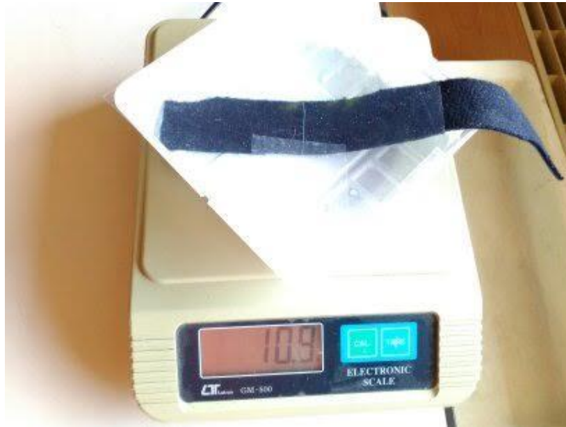
Obrázek 28 – měření vedení kapaliny distanční pleteninou
