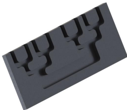
Obr. 4-22 Variant bifurkačného distribútora prúdenia.
