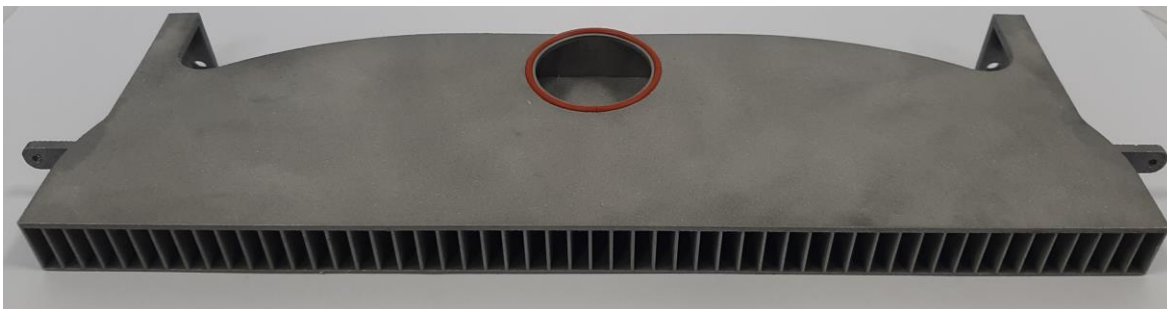
Obr. 12-3 Opracovaný spodný distribútor po odstránení podporných štruktúr a opieskovaní.
