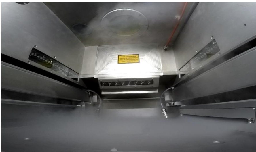
Obr. 1-1 Stavebná komora a vizualizácia prúdenia v jej objeme [3].
