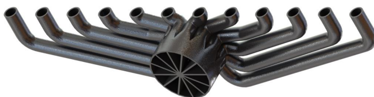
Obr. 4-23 Variant spodného distribútora prúdenia s využitím rozdelenia už v prívodnej trubke.
