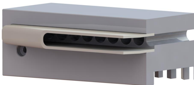
Obr. 5-15 Deflektor (biely) aj spolu s distribútorom v reze.
