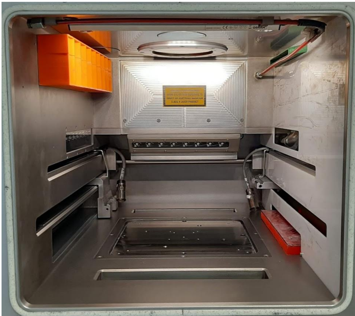
Obr. 5-25 Navrhnuté komponenty z ABS a PLA nainštalované v komore.
