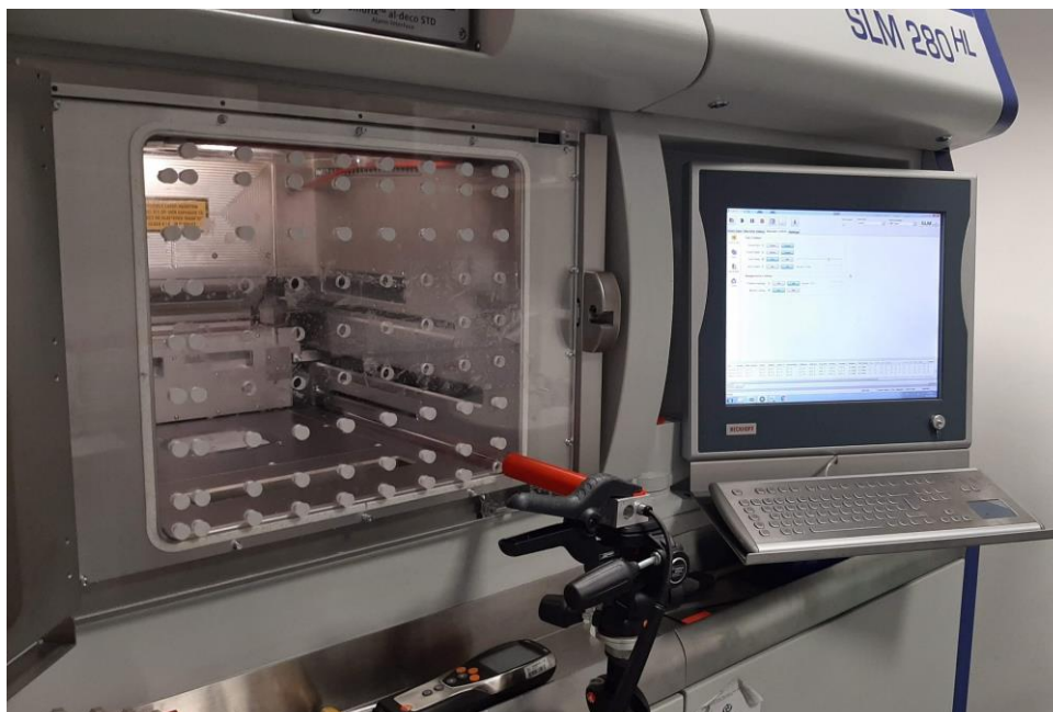
Obr. 4-2 Priebeh merania rýchlosti prúdenia, tesniaci element (červený).
