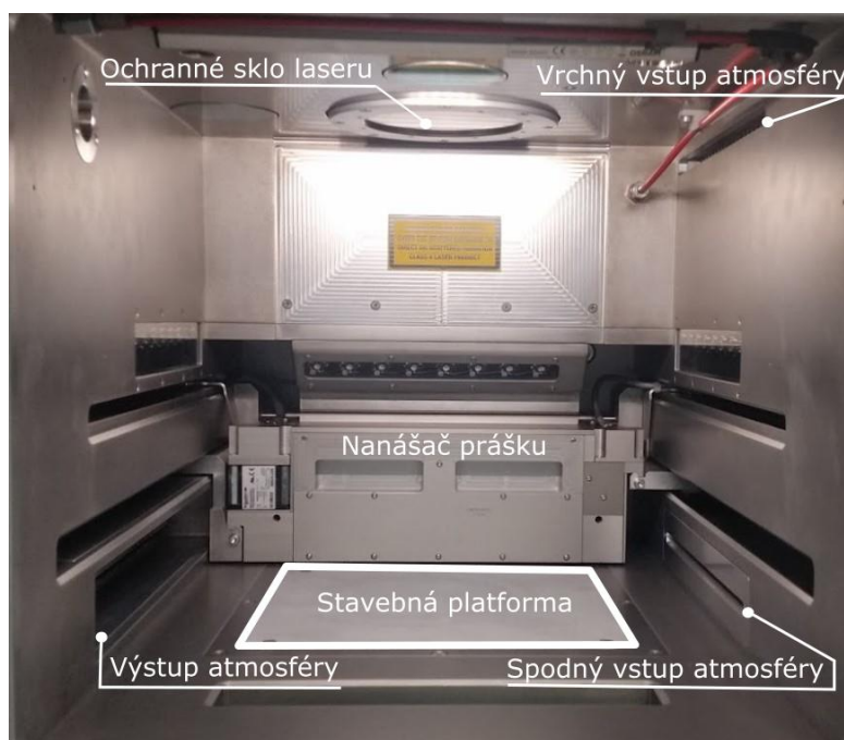
Obr. 2-2 Stavebná komora SLM.
