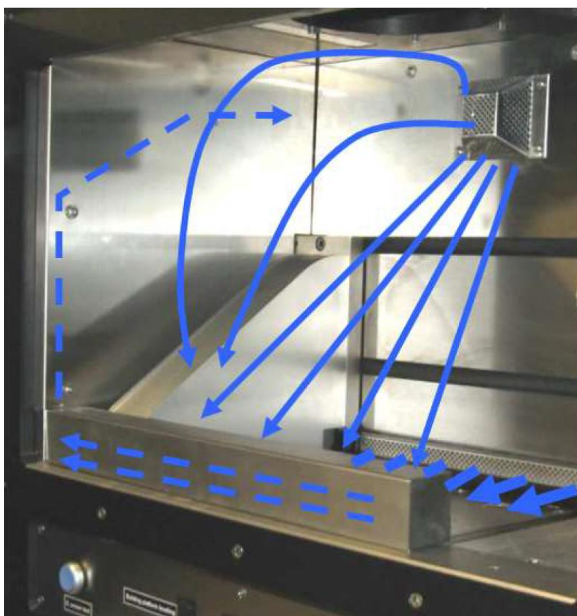
Obr. 2-5 Usmernené prúdenie v stavebnej komore EOS Eosint M280 [8].
