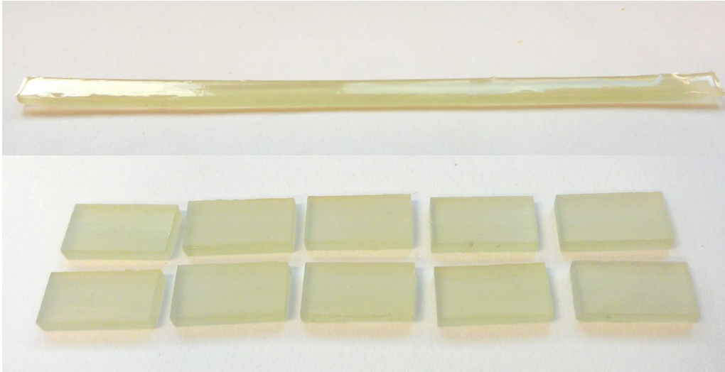
Obr. 3.3: Snímky kompozitního vzorku před řezáním a broušením (nahore) a po něm (dole)
