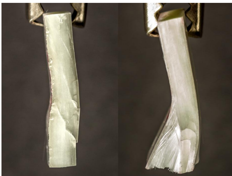
Obr. 4.7: Boční snímky krátkých trámečků s neupravenými vlákny po měření
