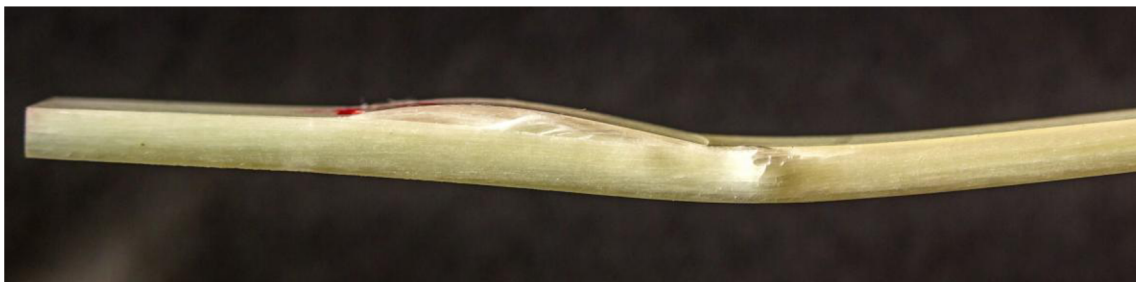
Obr. 4.15: Boční snímek vzorku s neupravenými vlákny po ohybové zkoušce
