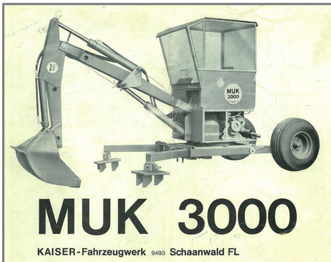
Obr. 2-2 Kráčivé rypadlo MUK3000 [2]
