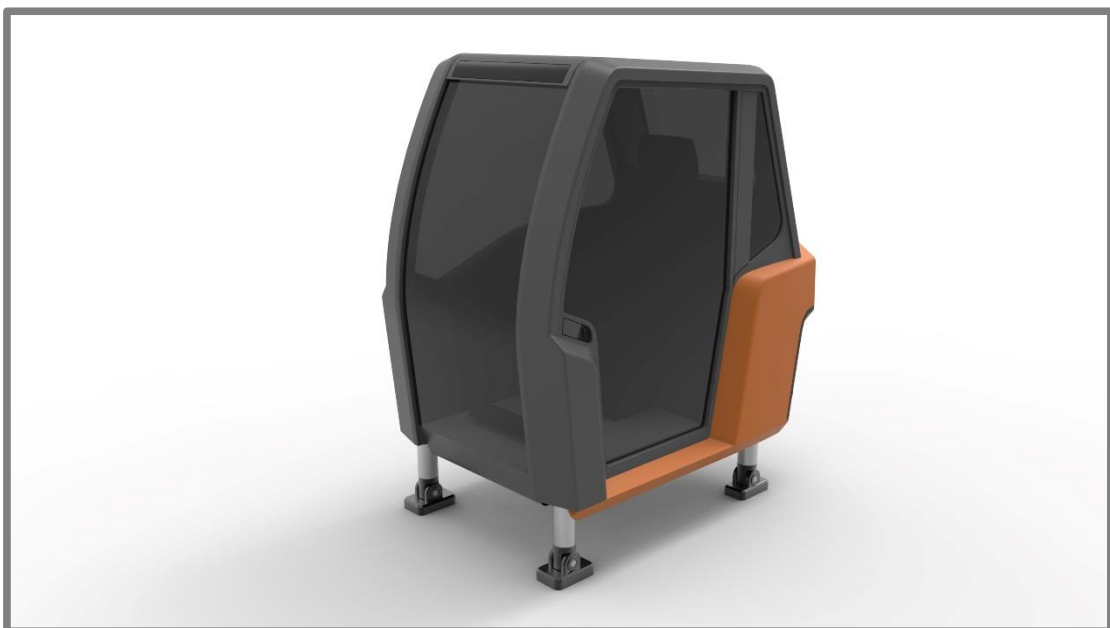
Obr. 5-36 Kabina jako samostatný prvek
