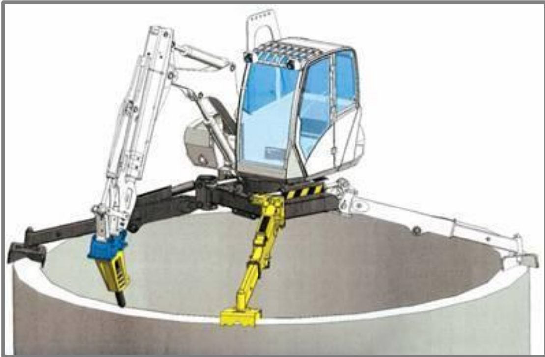
Obr. 2-14 Podvozek v úpravě pro demolicí komínů [16]
