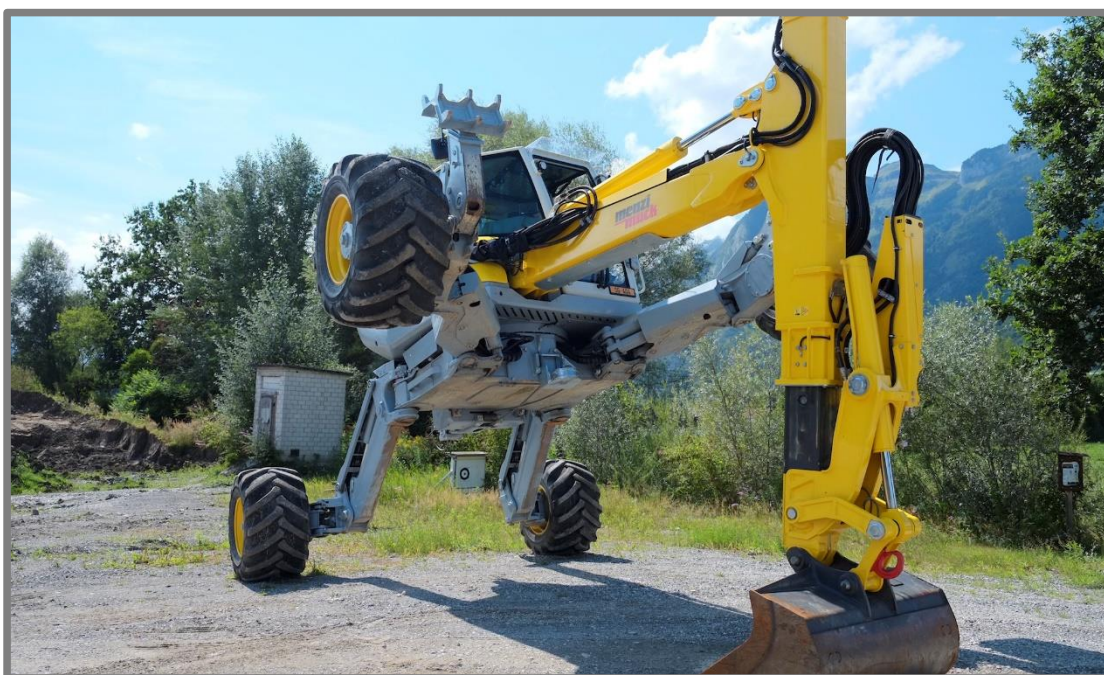
Obr. 2-13 Podvozek kráčivého rypadla [15]
