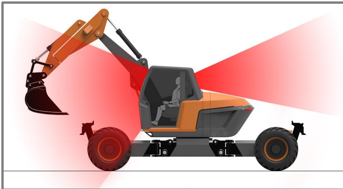
Obr. 6-51 Výhled z kabiny, boční pohled
