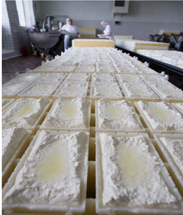
Obr. 5 Odkapávání syrovátky na odkapávacích stolech
