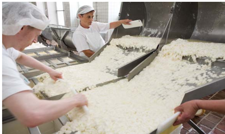
Obr. 4 Vylévání syrovátky a sýrového zrna z vaniček do forem
