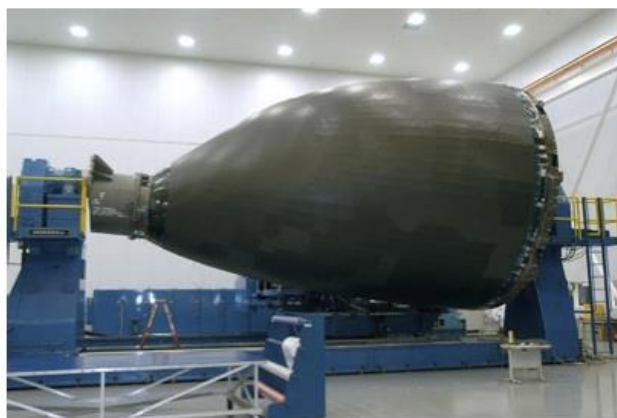
Obr. 37 Navíjení části trupu Boeingu 787 [25]
