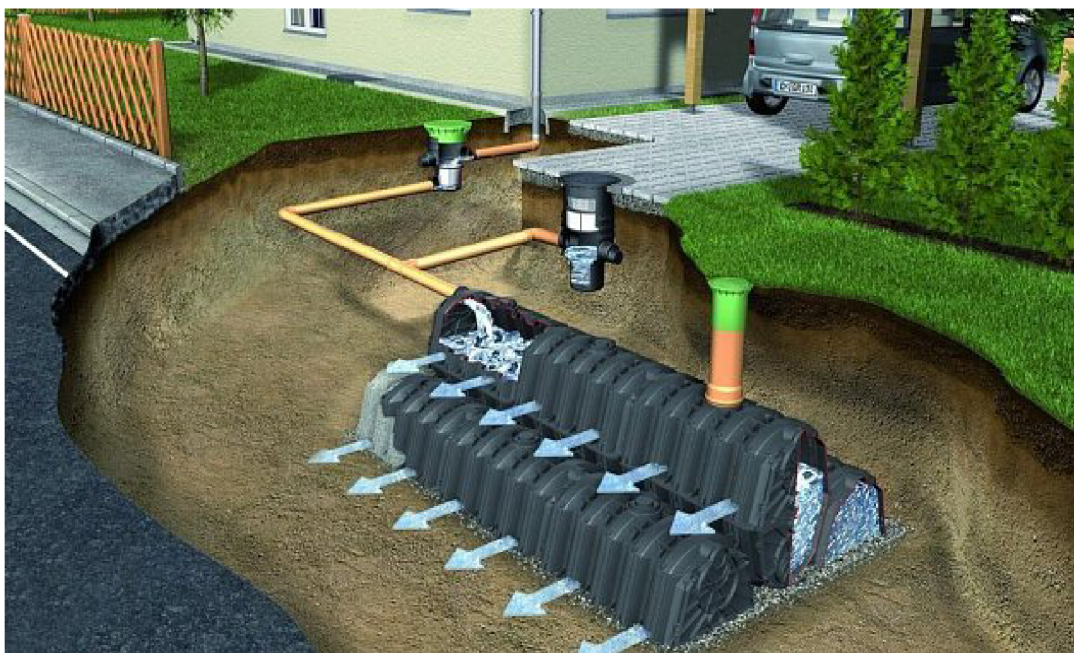
Obrázek 11 - Vsakovací tunelový systém AS-KRECHT [23]
