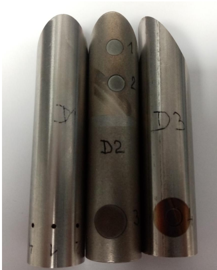
Obr. 5.12 Valcové pokusné vzorky vyrobené laserom
