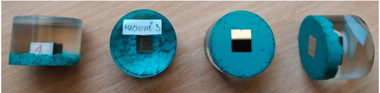
Obr. 5.8 Kapsle s drážkou
