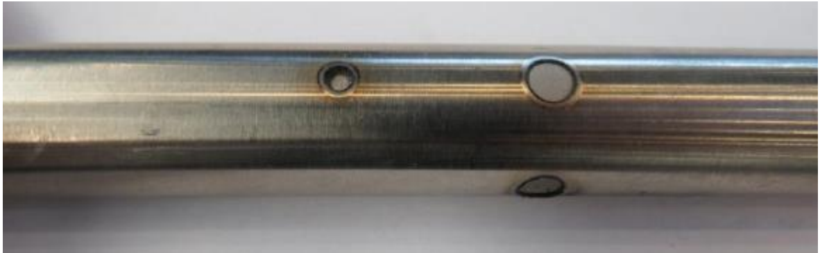
Obr. 5.15 Valcová testovacia mierka vyrobená laserom
