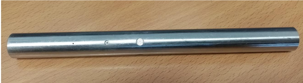
Obr. 5.17 Valcová testovacia mierka vyrobená metódou vyiskrovania
