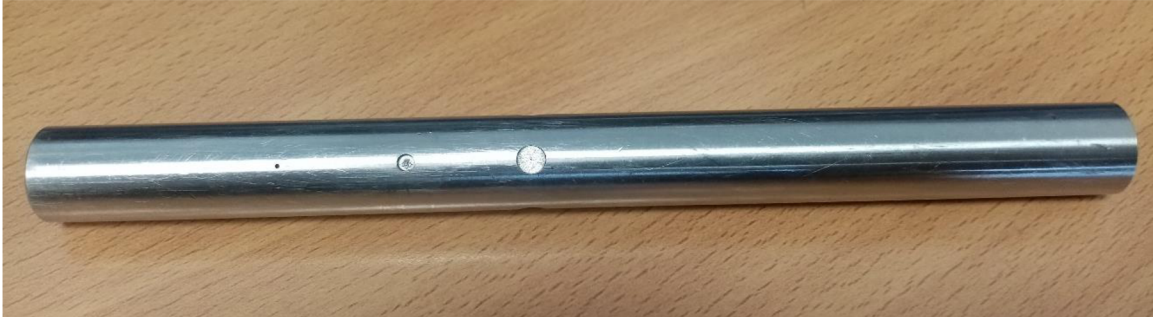
Obr. 5.17 Valcová testovacia mierka vyrobená metódou vyiskrovania
