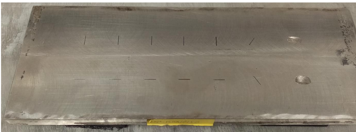
Obr. 5.1 Kalibračná mierka vyrobená vyiskrovaním
