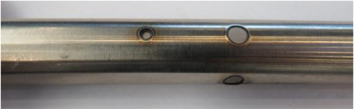
Obr. 5.15 Valcová testovacia mierka vyrobená laserom
