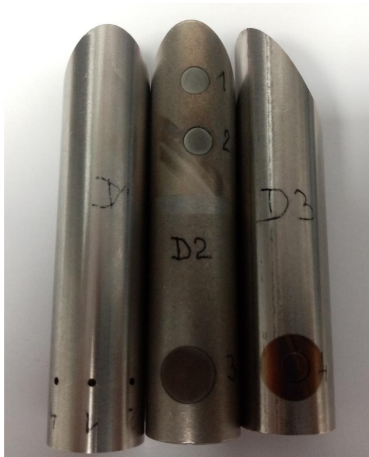
Obr. 5.12 Valcové pokusné vzorky vyrobené laserom
