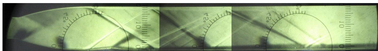
Obr. 6.25 – Šlírové snímky proudění vzduchu v kanále v konfiguraci M22rv5
