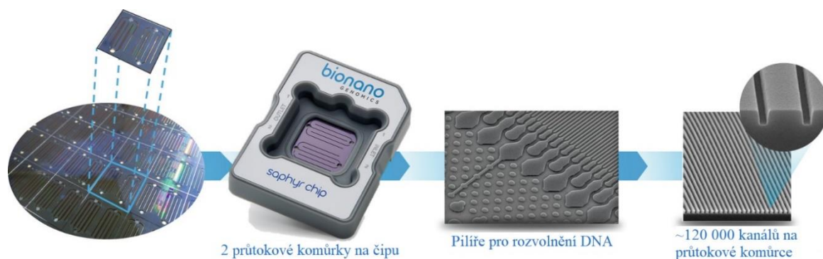
Obr. 16 Detail nanokanálového čipu využívaný u systému Saphyr (Chan et al. , 2018).
