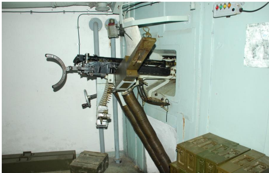
Obr. 112 – dvojče TK vz. 37 ve střelecké místnosti pěchotního srubu, vpravo patrné signalizační zařízení pro koordinaci palby pozorovatelem ze zvonu, nad zbraní pak střelecká mapa s ukazatelem, muzeum KS – 5, současný stav, archiv J. Hrubeckého
