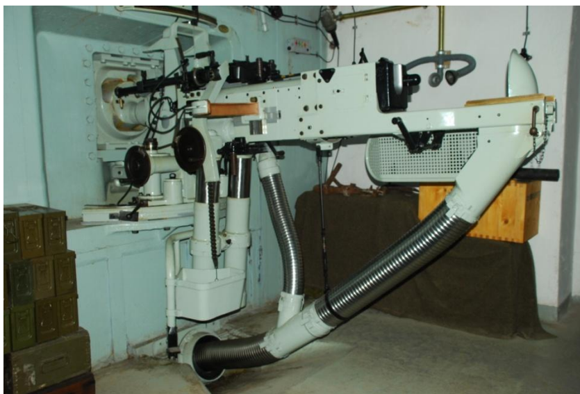
Obr. 110 – zbraň L1 ve střílně pěchotního srubu, patrné masivní odvody vystřílených nábojnic do příkopu před stílnami, muzeum KS – 5, současný stav, archiv J. Hrubeckého
