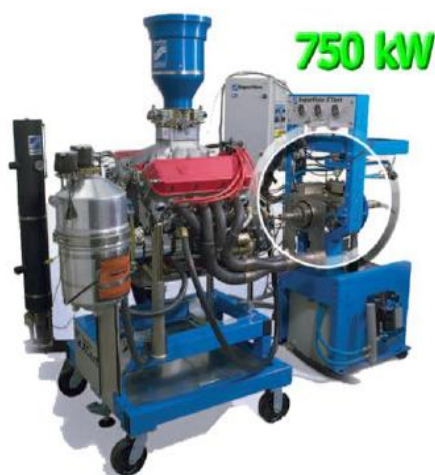
Obr. 8 Hydraulický dynamometr pro osobní automobily (Čupera, 2010)
