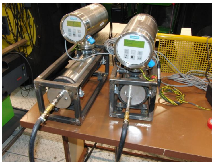
Obr. 28 Coriolisovy hmotnostní průtokoměry v diferenciálním zapojení
