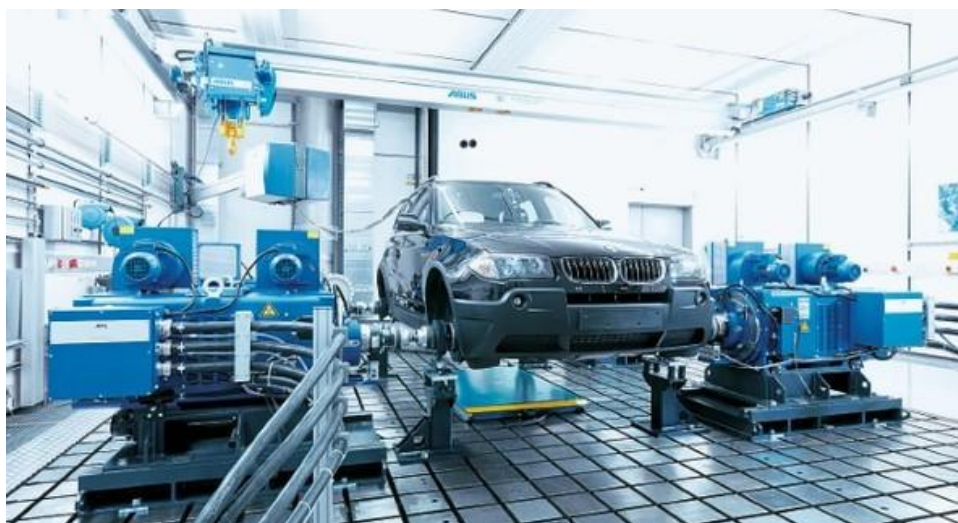
Obr. 15 Vozidlový dynamometr bezválcové konstrukce rakouské firmy AVL ( http://www.avl.com )
