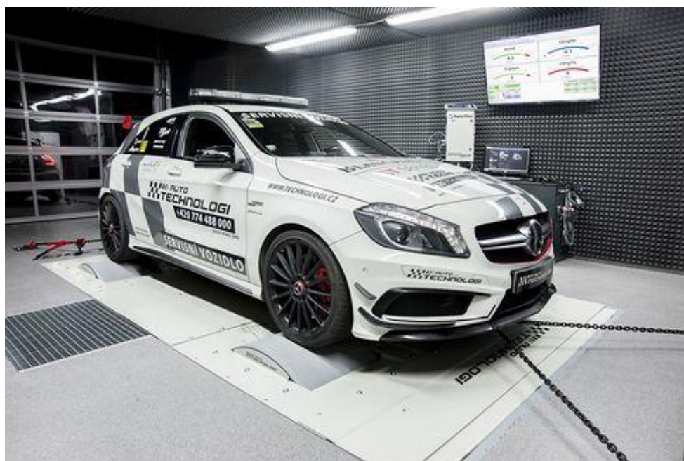
Obr. 2 Test Mercedes-Benz F1 A45 AMG na válcové zkušebně ( http://www.carshouse.cz/nova-valcova-zkusebna-vykonu-v-praze )
