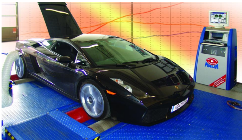
Obr. 13 Vozidlový dynamometr s párovými válci (Čupera, 2010)
