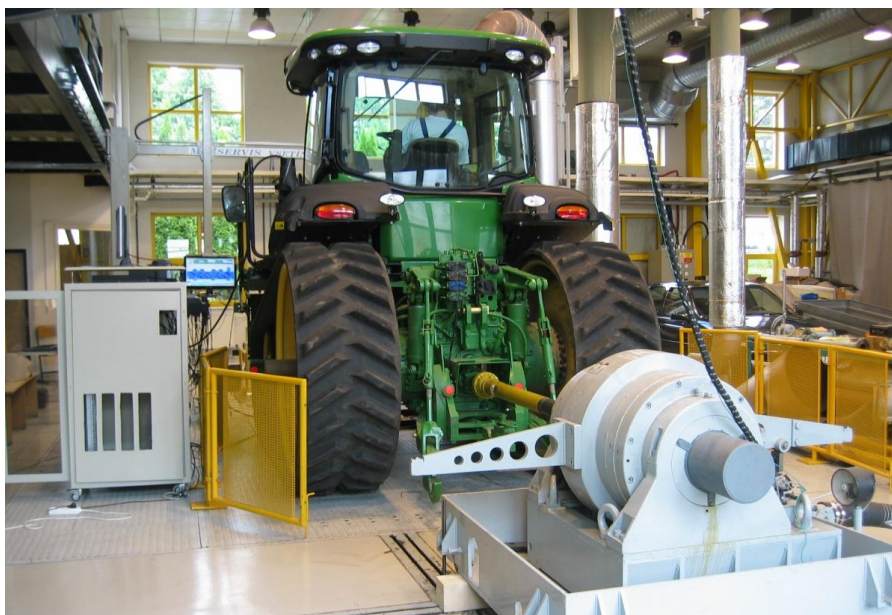
Obr. 26 Vířivý dynamometr V500 připojený k vývodové hřídeli pásového traktoru
