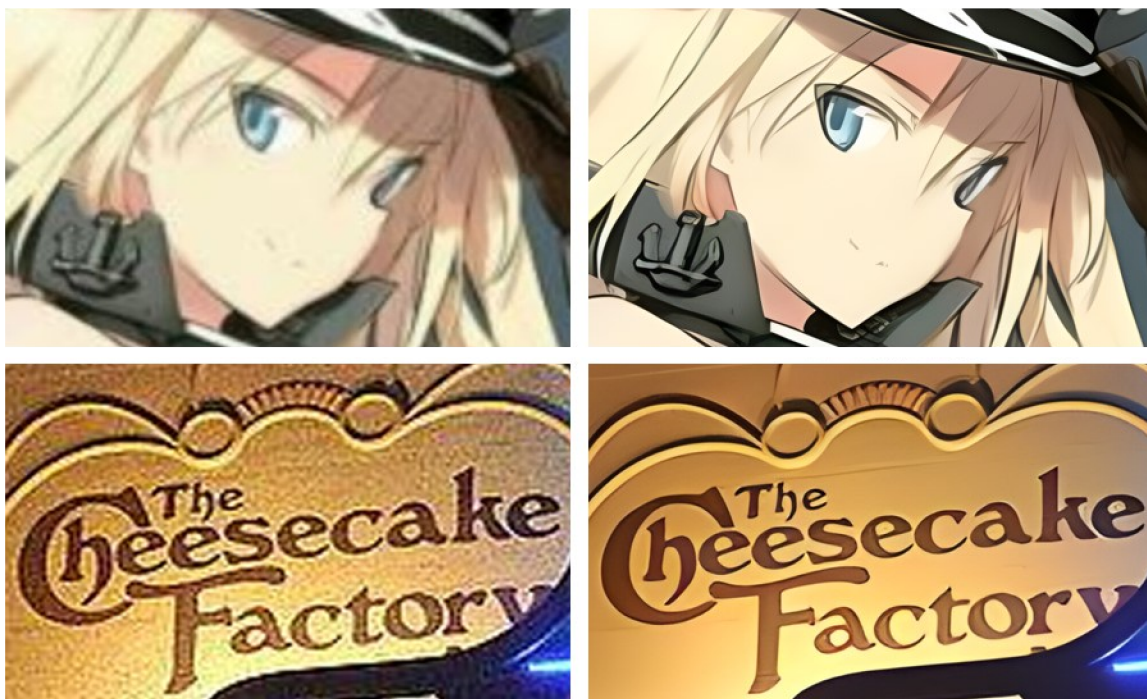
Obrázek 4.7: Ukázka zvýšení rozlišení pomocí techniky Real-ESRGAN. Původní obrázek vlevo, zvětšený vpravo. Obrázky jsou převzaty z [23] (Upraveno).
