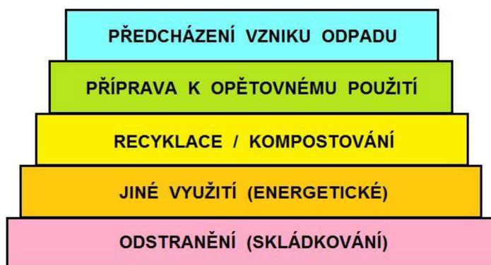
Obr. 2: Hierarchie odpadového hospodářství [7]
