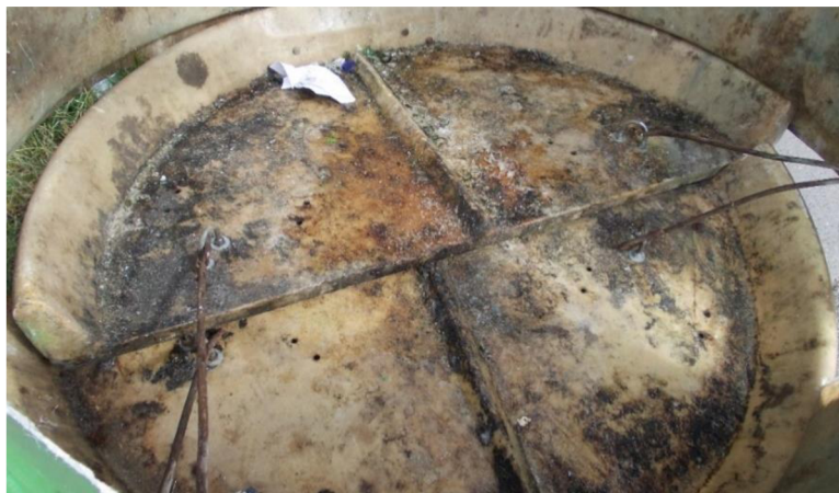
Obr. 6: Dno používaného zvonového kontejneru rozevratelné ze středu nádoby [18]
