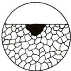
Obr. 6 Schéma důlkové koroze [31]
