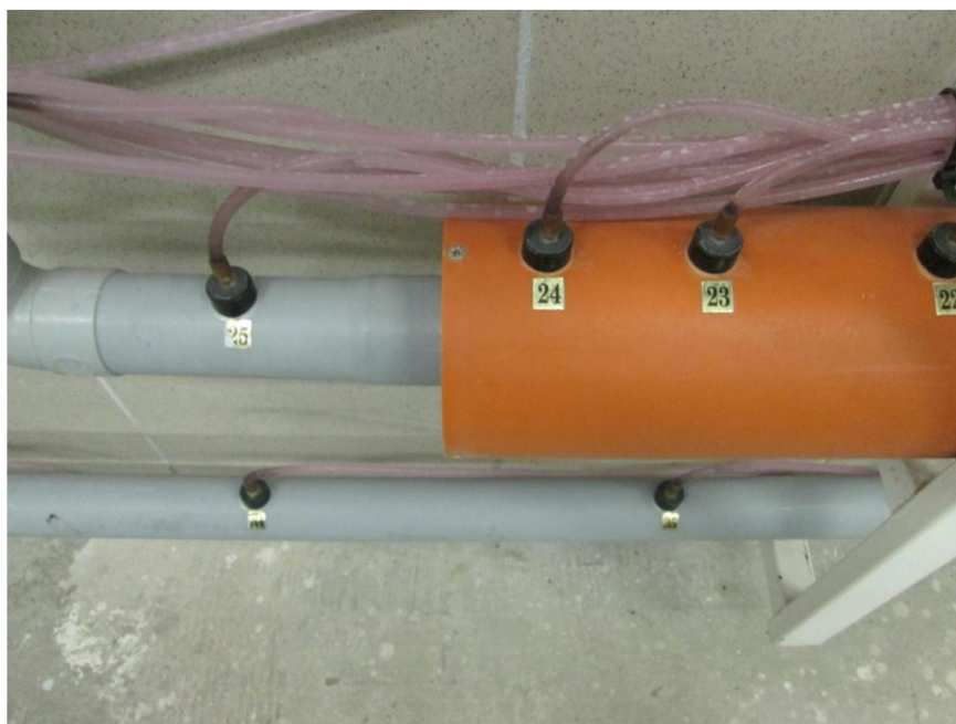
Obr. 51 Náhlé zúžení-piezometrické trubičky
