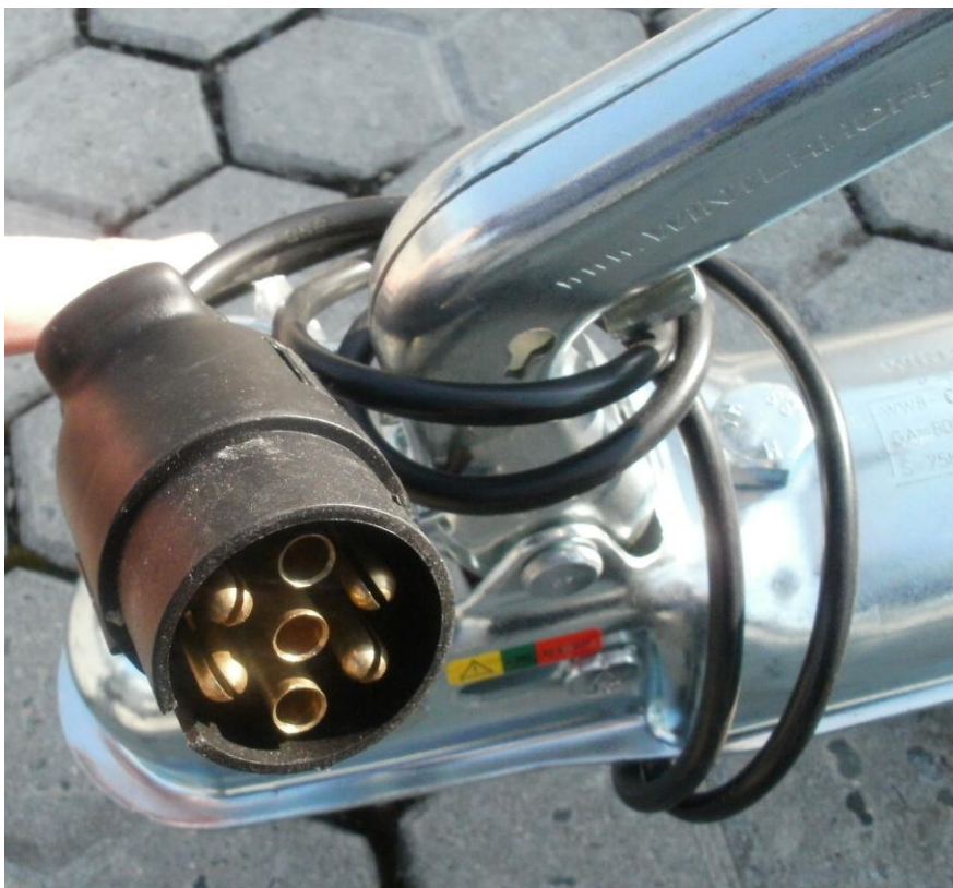
Příloha 35: Foto elektrické zástrčky, 7 pólové, u spojovacího zařízení přívěsu kategorie O 1 a její zapojení.
