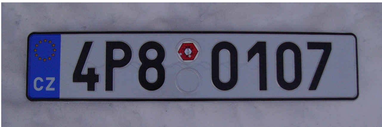
Příloha 32: Kontrolní nálepka o kontrole technické způsobilosti silničního vozidla s vyznačením měsíce a roku příští pravidelné technické prohlídky.
