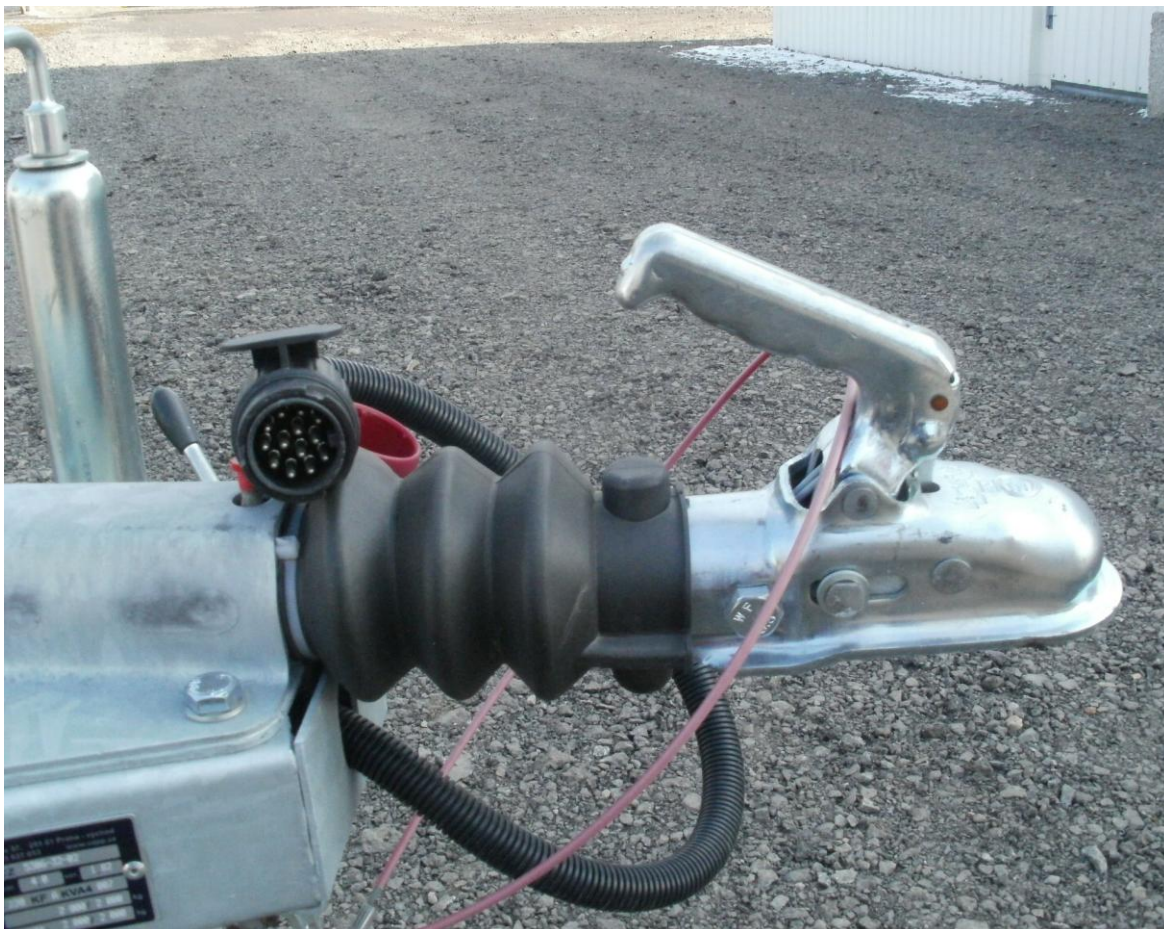
Příloha 38: Foto spojovacího zařízení, nájezdové brzdy a elektrické zástrčky, 13 pólové u přívěsu kategorie O 2 a její zapojení.
