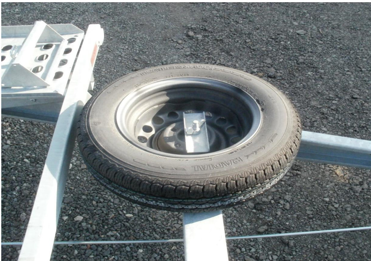
Příloha 43: Foto náhradního kola, umístěného na přívěsu kategorie O 2 .
