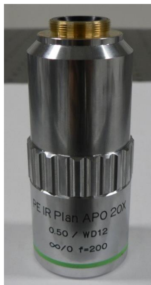
Obrázek 4.3: Mikroskopový objektiv PE IR Plan APO 20x od SEIWA OPTICAL Co.
