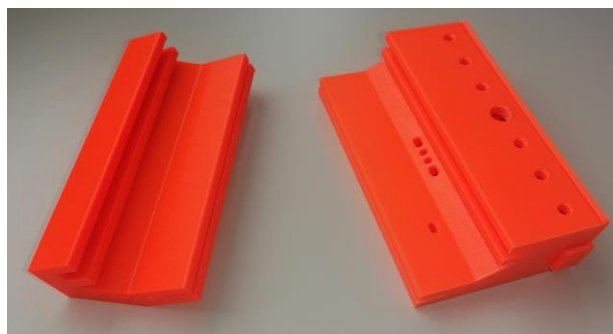
Obrázok 4.10 Vyrobené svorky pre ohrievací panel
