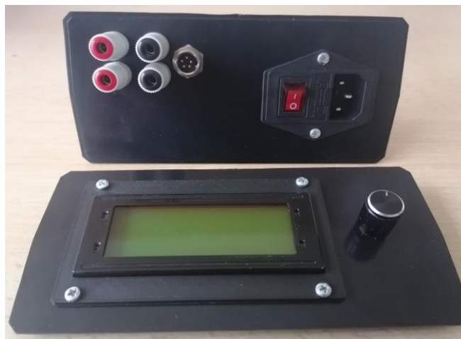
Obrázok 4.4 Osadenie elektrických periférií v otvoroch
