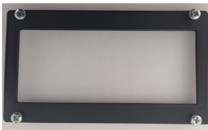
Obrázok 4.7 Vyrobený plastový rám
