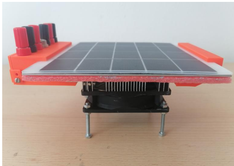
Obrázok 4.8 Konštrukcia ohrievacieho panelu
