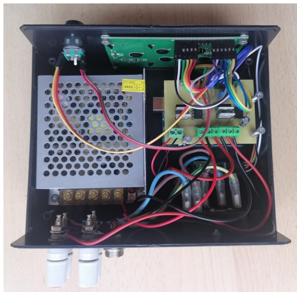
Obrázok 4.6 Umiestnenie prvkov v krabičke (s kabelážou)
