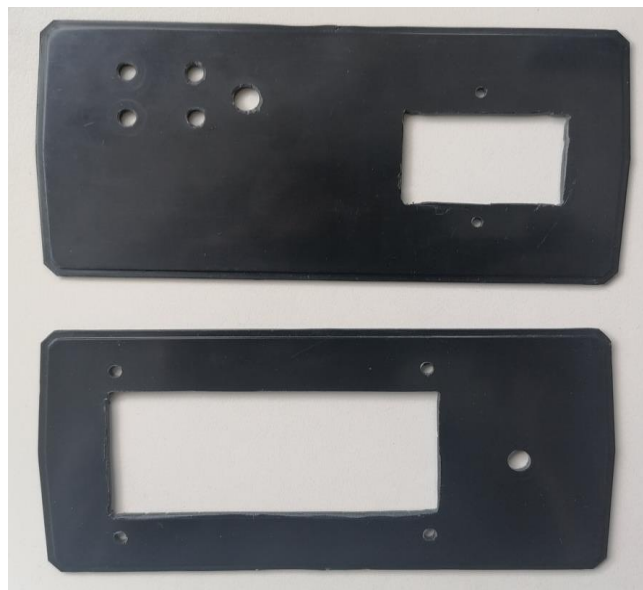
Obrázok 4.3 Vytvorenie otvorov v krabičke
