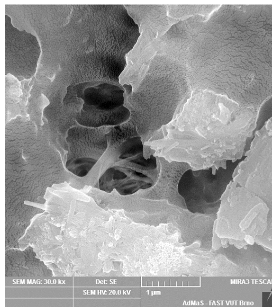
Obr. 26 REM 6 % EVA, zvětšení 30 000× viditelný polymerní film po ošetřování vzorku ve střídavých podmínkách
