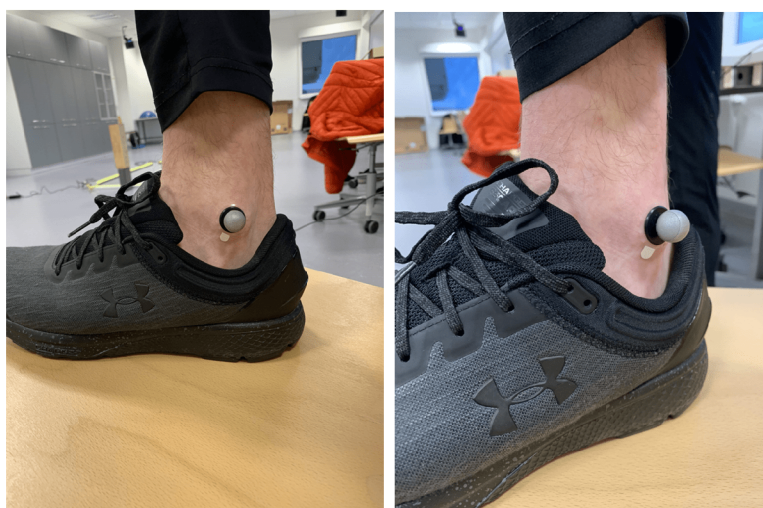
Obr. 3.3: Rozmístění markerů na nohou probanda
