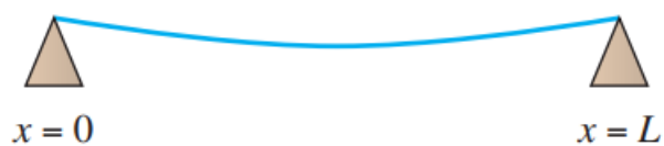
Obrázek 2.2: Oboustranně podepřený nosník
