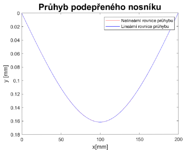
Obrázek 4.14: Oboustranně podepřený nosník se silou F ve středu intervalu
