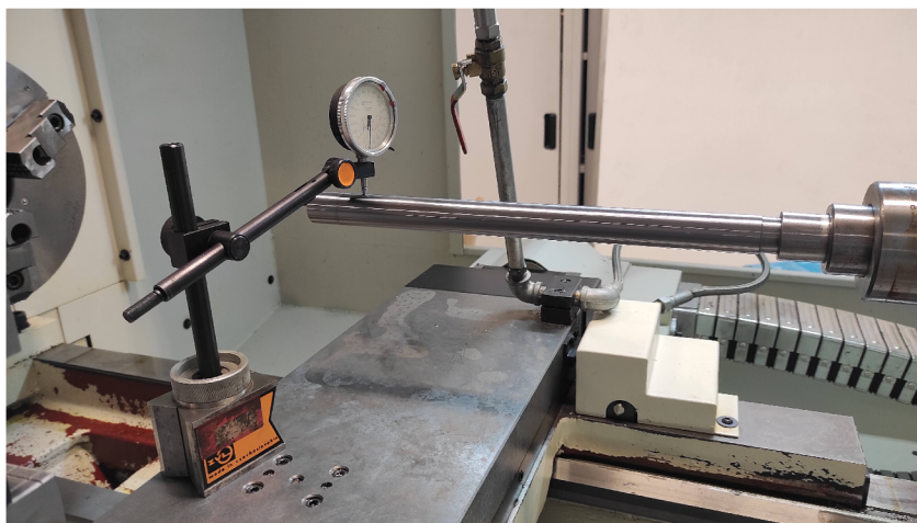
Obr. 36 Měření rovnoběžnosti kuželové dutiny hrotové objímky s pohybem suportu v rovině svislé
