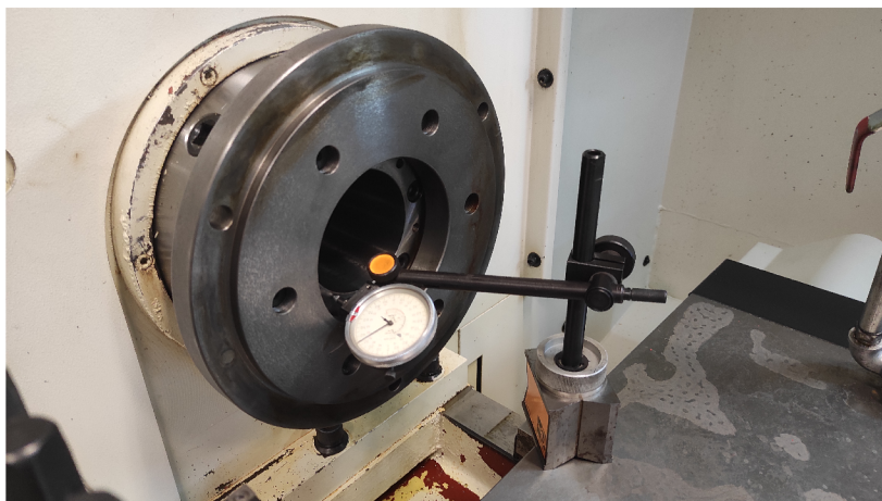
Obr. 27 Měření čelního házení opěrné plochy vřetena
