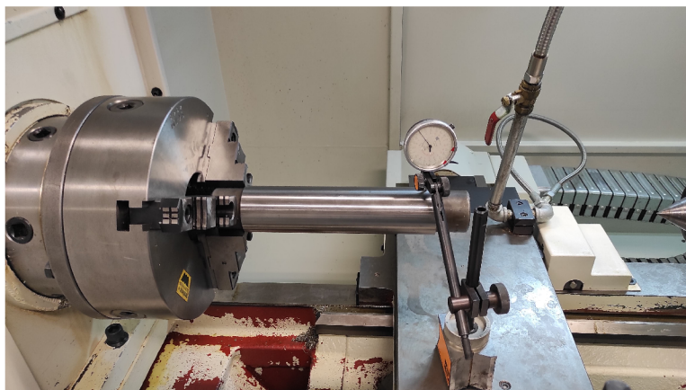
Obr. 32 Měření rovnoběžnosti osy vřetena s podélným pohybem suportu v rovině svislé
