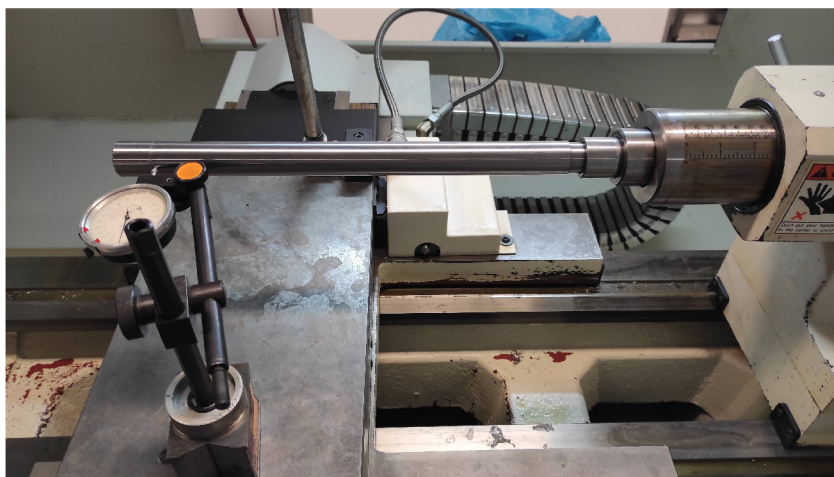
Obr. 35 Měření rovnoběžnosti kuželové dutiny hrotové objímky s pohybem suportu v rovině vodorovné
