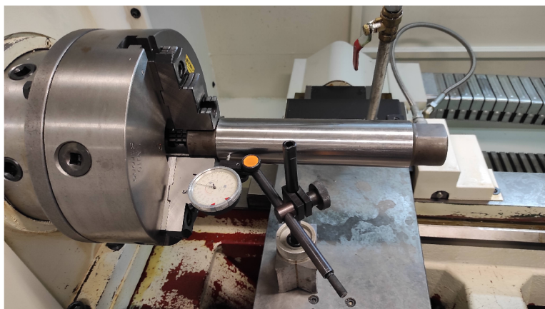
Obr. 31 Měření rovnoběžnosti osy vřetena s podélným pohybem suportu v rovině vodorovné
