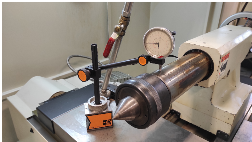
Obr. 34 Měření rovnoběžnosti pohybu suportu s hrotovou objímkou v rovině svislé
