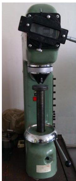
Obr. 20 Přístroj na měření tvrdosti
