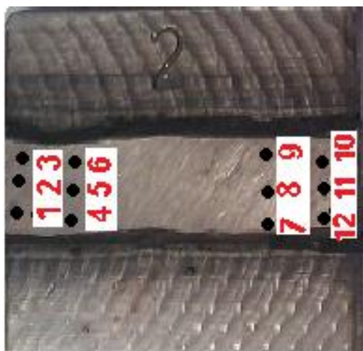
Obr. 19 Naznačení vtisků na vzorku
