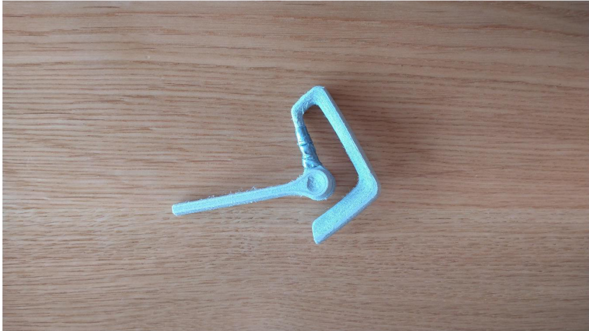
Obr 6-4 Vtištěný model (materiál TPU)
