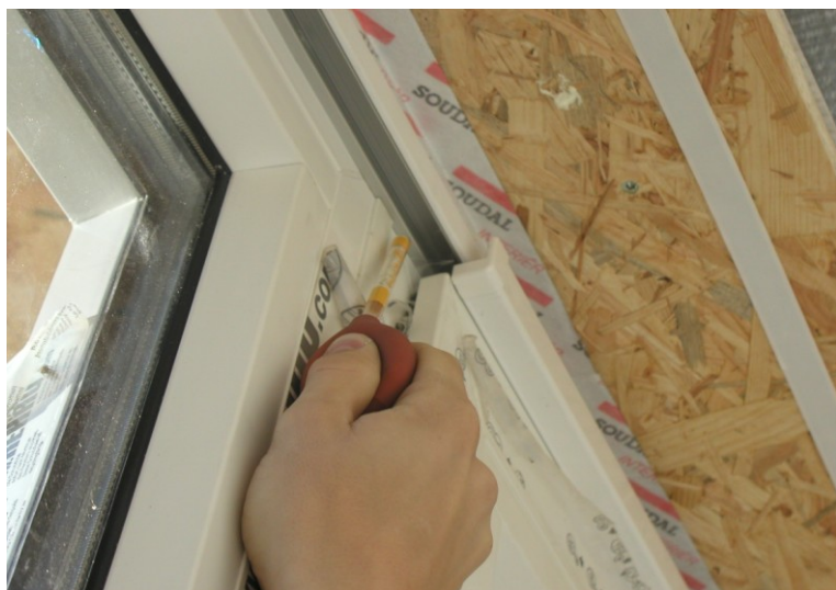
Obr. 6 Zjišťování průvzdušnosti u funkční spáry oken.
