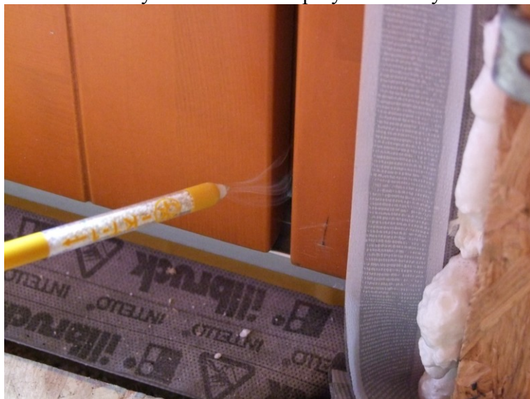
Obr. 4 Zjišťování úniků ve spojení podlahové a obvodové konstrukce
