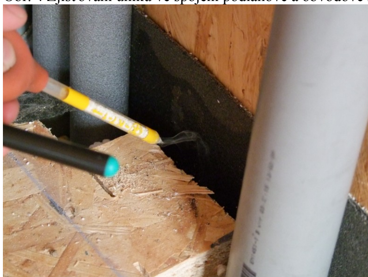
Obr. 4 Zjišťování úniků ve spojení podlahové a obvodové konstrukce
