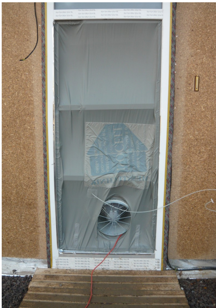
Obr. 4 Vnější pohled vstupních zárubní opatřených Blower-door systémem pro vytvoření přetlaku/podtlaku.
