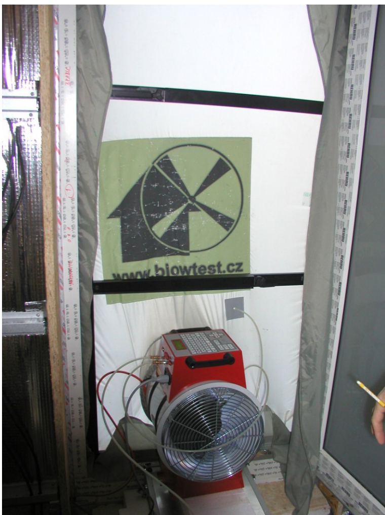
Obr. 9 Vnitřní pohled na Blower-door systém.
