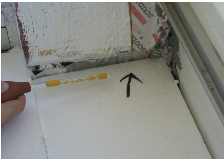
Obr. 8 Zjišťování propustnosti pláště u podlahové izolace.
