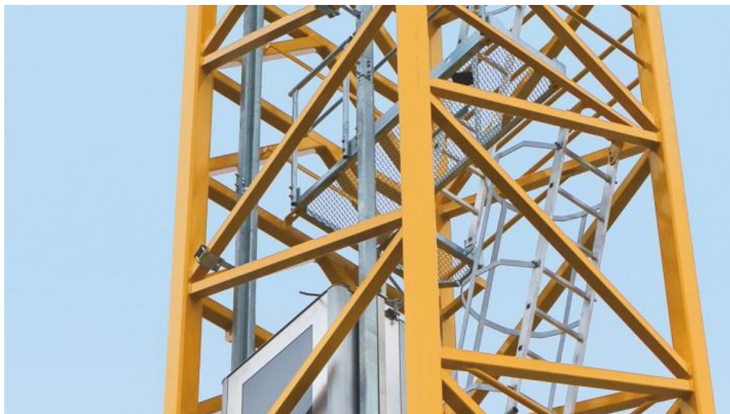
Obr. 5: Svařovaná příhradová konstrukce věžového jeřábu Liebherr 16 EC 240 [84].
