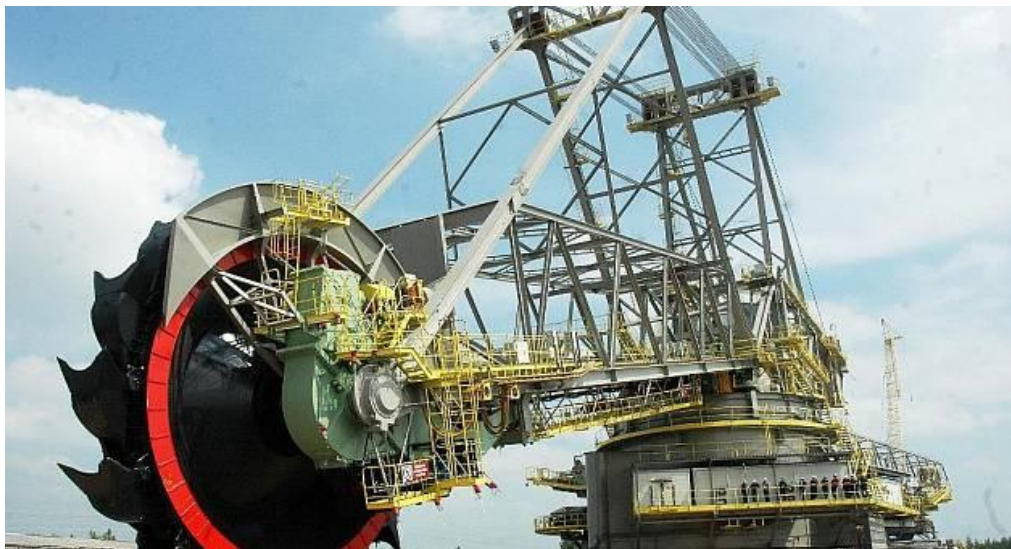
Obr. 9: Kolesové rypadlo KK 1300, jedná se o velice moderní svařovanou příhradovou konstrukci, jejíž styčníky jsou realizovány pomocí styčnickových plechů [24].
