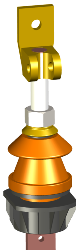
Obr. 4.2: Kompletní konstrukční model NN průchodky 1 kV/630 A
